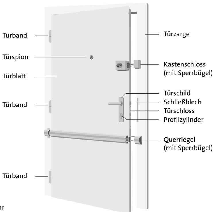
und die Tür gleichzeitig an beiden Seiten verriegelt. Der Sperrbügel verhindert, dass sich die Tür von außen öffnen lässt. Das Eindringen ungebetener Gäste kann so verhindert werden.
